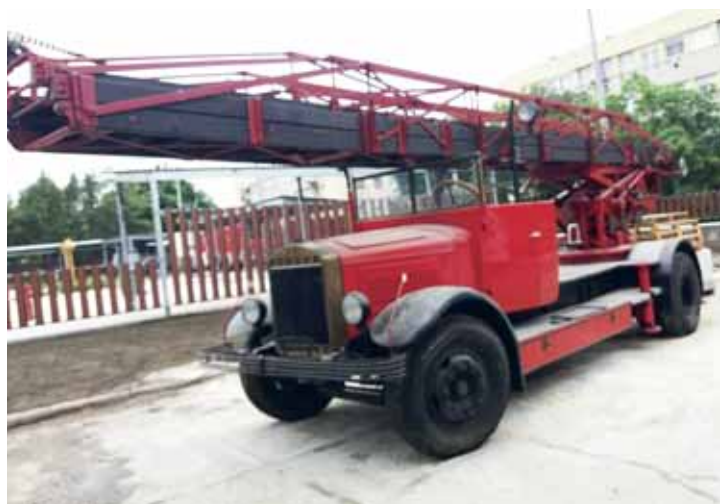
Az 1928-ban gyártott fa alváz as RÁBA létraszer (30 méteres)
