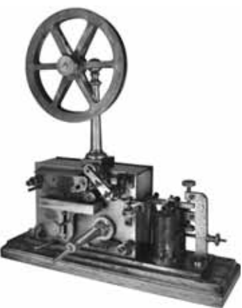
Stenzer-féle kékíró vasúti távírógép
